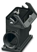
Custodia a zoccolo B16, con blocc. longitudinale, materiale: PA 6.6-FR, uscite cavi: 2, laterali, 2x M25, altezza: 84 mm, connessione a vite per cavo: senza, Standard, inclusi 2 adattatori di riduzione
