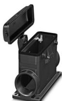
Custodia a zoccolo B24, per bloccaggio trasversale, materiale: PA 6.6-FR, materiale coperchio: PC, uscite cavi: 2, laterali, 2x M32, altezza: 84 mm, connessione a vite per cavo: senza, coperchio di protezione: sì, Standard, inclusi 2 adattatori di riduzione
