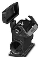
Custodia a zoccolo B16, con blocc. longitudinale, materiale: PA 6.6-FR, materiale coperchio: PC, uscite cavi: 2, laterali, 2x M32, altezza: 84 mm, connessione a vite per cavo: senza, coperchio di protezione: sì, Standard, inclusi 2 adattatori di riduzione
