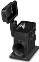
Custodia a zoccolo B10, per bloccaggio trasversale, materiale: PA 6.6-FR, materiale coperchio: PC, uscite cavi: 2, laterali, 2x M25, altezza: 74 mm, connessione a vite per cavo: senza, coperchio di protezione: sì, Standard, inclusi 2 adattatori di riduzione
