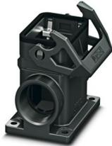
Custodia a zoccolo B6, con blocc. longitudinale, materiale: PA 6.6-FR, uscite cavi: 2, laterali, 2x M25, altezza: 74 mm, connessione a vite per cavo: senza, Standard, inclusi 2 adattatori di riduzione
