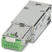
Inserto portacontatti maschio RJ45, tipo: RJ45, grado di protezione: IP20, numero poli: 8, 1 Gbit/s, CAT5 (IEC 11801:2002), materiale: Metallo, tipo di connessione: Connessione a perforazione di isolante, sezione di connessione: AWG 23- 22, uscita cavo: diritto, Ethernet/PROFINET
