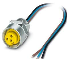
Connettore da incasso, 3-poli, Femmina, diritto, 7/8"-16UNF, su estremità conduttore libera, Montaggio anteriore con filettatura 1/2"-14 NPT, Fili singoli, lunghezza cavo: 1 m, 0,75 mm<sup>2</sup>, filo in PVC
