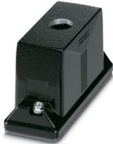
Custodia protettiva B24, con bloccaggio a vite, materiale: Pressofuso di alluminio, impermeabile, uscite cavi: 1, diritto, 1x M25, altezza: 74 mm, connessione a vite per cavo: senza, requisiti ambientali elevati
