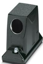
Custodia protettiva B16, con bloccaggio a vite, materiale: Pressofuso di alluminio, impermeabile, uscite cavi: 1, laterali, 1x M40, altezza: 93,7 mm, connessione a vite per cavo: senza, requisiti ambientali elevati
