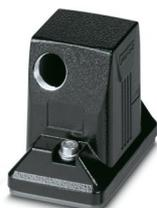
Custodia protettiva B6, con bloccaggio a vite, materiale: Pressofuso di alluminio, impermeabile, uscite cavi: 1, laterali, 1x M20, altezza: 74 mm, connessione a vite per cavo: senza, requisiti ambientali elevati
