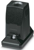
Custodia protettiva B6, con bloccaggio a vite, materiale: Pressofuso di alluminio, impermeabile, uscite cavi: 1, diritto, 1x M25, altezza: 93,7 mm, connessione a vite per cavo: senza, requisiti ambientali elevati
