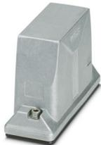
Custodia protettiva B24, con bloccaggio a vite, materiale: Pressofuso di alluminio, impermeabile, variabile, altezza: 93,7 mm, connessione a vite per cavo: senza, Offshore/EMC, senza apertura filettata per l'avvitamento, Guarnizione conduttiva (caratteristiche EMC)
