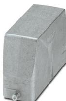
Custodia protettiva B24, per bloccaggio longitudinale, materiale: Pressofuso di alluminio, impermeabile, variabile, altezza: 76 mm, connessione a vite per cavo: senza, Standard, senza apertura filettata per l'avvitamento
