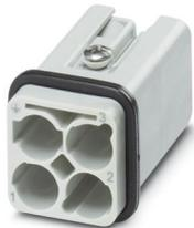
Inserto contatti, numero poli: 3+PE, dimensioni: D7, numero di connessioni per polo: 1, Spina, Connessione a crimpare, 400 V, 40 A, 1,5 mm<sup>2</sup> ... 6 mm<sup>2</sup>, applicazione: Potenza
