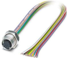
Connettore per apparecchi posteriore, Universale, 17-poli, Femmina, diritto, M12-Standard, codifica: A, su estremità conduttore libera, Montaggio posteriore, M16 x 1,5, Fili singoli, lunghezza cavo: 0,5 m, 0,14 mm<sup>2</sup>, Filo in TPE, saldato, Prodotto alternativo secondo RoHS II senza eccezione 6c (Pb < 0,1 %) cod. art.: 1239284
