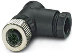
Connettore Power, 3-poli, Femmina angolato M12, codifica: S, Connessione a vite, materiale zigrinato: Pressogetto di zinco, nichelato, connessione a vite per cavo Pg9, diametro esterno conduttore 6 mm ... 8 mm, per corrente alternata fino a 16 A/630 V
