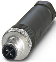
Connettore Power, 3-poli, Maschio diritto M12, codifica: S, Connessione a vite, materiale zigrinato: Pressogetto di zinco, nichelato, connessione a vite per cavo Pg9, diametro esterno conduttore 6 mm ... 8 mm, per corrente alternata fino a 16 A/630 V, Contatto 4 anticipato
