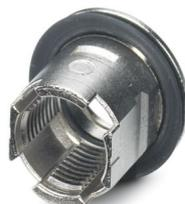
Boccola filettata M12 con funzione di compensazione tolleranza, per inserti femmina M12 compatibili con THR diritti. Adatta per spessori di parete pannelli frontali di 3,1 mm... 3,9 mm.
