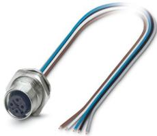
Connettore per apparecchi posteriore, Universale, 5-poli, Femmina, diritto, M12, codifica: A, su estremità conduttore libera, Montaggio posteriore, M16 x 1,5, Fili singoli, lunghezza cavo: 1 m, 0,34 mm<sup>2</sup>, Filo in TPE, saldato, Prodotto alternativo secondo RoHS II senza eccezione 6c (Pb < 0,1 %) cod. art.: 1239267
