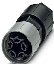
Connettore, product family: QPD, tipo di connessione: Connessione IDC, 0,5 mm<sup>2</sup> ... 1,5 mm<sup>2</sup>, 690 V, 17,5 A, PA, nero, con dado QUICKON, codifica: Profilo di codifica, diametro esterno conduttore: 5 mm ... 7 mm e 7 mm ... 9,5 mm, identificazione delle connessioni: 1, 2, 3
