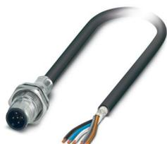
Connettore per apparecchi posteriore, Universale, 5-poli, PUR senza alogenati, grigio-nero RAL 7021, schermata, Connettore, diritto, M12-SPEEDCON, codifica: A, su estremità conduttore libera, Montaggio posteriore, M16 x 1,5, Collegamento del cavo, lunghezza cavo: 1 m, PUR senza alogenati nero, Prodotto alternativo secondo RoHS II senza eccezione 6c (Pb < 0,1 %) cod. art.: 1239254
