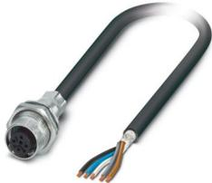
Connettore per apparecchi posteriore, Universale, 5-poli, PUR senza alogenati, grigio-nero RAL 7021, schermata, Femmina, diritto, M12-SPEEDCON, codifica: A, su estremità conduttore libera, Montaggio posteriore, M16 x 1,5, Collegamento del cavo, lunghezza cavo: 1 m, 0,34 mm<sup>2</sup>, PUR senza alogenati nero, Prodotto alternativo secondo RoHS II senza eccezione 6c (Pb < 0,1 %) cod. art.: 1239247
