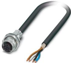
Connettore per apparecchi posteriore, Universale, 4-poli, PUR, grigio-nero RAL 7021, Femmina, diritto, M12-SPEEDCON, codifica: A, su estremità conduttore libera, Montaggio posteriore, M16 x 1,5, Collegamento del cavo, lunghezza cavo: 2 m, PUR senza alogenati nero, Prodotto alternativo secondo RoHS II senza eccezione 6c (Pb < 0,1 %) cod. art.: 1239246
