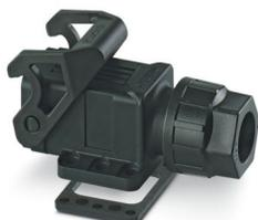
Custodia a zoccolo D7, con blocc. longitudinale, materiale: PA, uscite cavi: 1, diritto, M20, altezza: 27,9 mm, connessione a vite per cavo: con, Standard, base aperta
