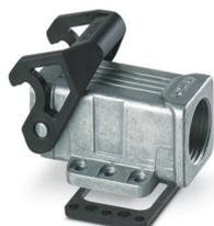
Custodia a zoccolo D7, con blocc. longitudinale, materiale: Pressofuso di alluminio, impermeabile, uscite cavi: 1, diritto, 1x M20, altezza: 27,9 mm, connessione a vite per cavo: senza, Standard, base aperta
