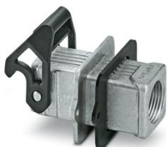
Custodie passaparete D7, con blocc. longitudinale, materiale: Pressofuso di alluminio, impermeabile, uscite cavi: 1, diritto, 1x M20, altezza: 60,5 mm, connessione a vite per cavo: senza, Standard
