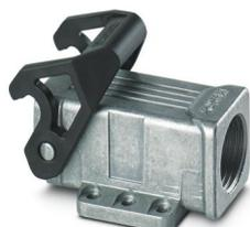
Custodia a zoccolo D7, con blocc. longitudinale, materiale: Pressofuso di alluminio, impermeabile, uscite cavi: 1, diritto, 1x Pg11, altezza: 27,9 mm, connessione a vite per cavo: senza, Standard, Fondo chiuso
