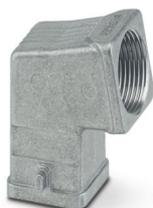
Custodia protettiva D7, per bloccaggio longitudinale, materiale: Pressofuso di alluminio, impermeabile, uscite cavi: 1, laterali, 1x M25, altezza: 52,8 mm, connessione a vite per cavo: senza, Standard
