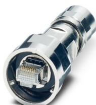
Connettore RJ45, tipo: RJ45, grado di protezione: IP67, numero poli: 8, 1 Gbit/s, CAT5 (IEC 11801:2002), materiale: Metallo, tipo di connessione: Connessione rapida IDC, sezione di connessione: AWG 27- 24, uscita cavo: diritto, colore: argento
