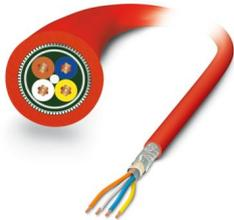
In metri, Cavo dati, Sercos CAT5 (100 MBit/s), schermata, PVC/PVC, rosso traffico RAL 3020, 4-conduttori (1x4xAWG22/7, SF/TQ), colore conduttore singolo: bianco, giallo, blu, arancio, lunghezza cavo: 100 m
