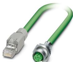
Cavo EtherCAT® confezionato, schermato, stella quadrupla, AWG 22 flessibile (7 fili), RAL 6018 (giallo-verde), connettore femmina da incasso M12, SPEEDCON, 4 poli su connettore RJ45/IP20, lunghezza: 2,0 m
