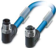
Cavo di sistema bus, PROFIBUS PA (31,25 kBit/s), 3-poli, PVC, blu RAL 5015, schermata, Maschio angolato M12, codifica: A, su Connettore femmina angolato M12, codifica: A, lunghezza cavo: 5 m, per area Ex con zigrinatura in acciaio inox
