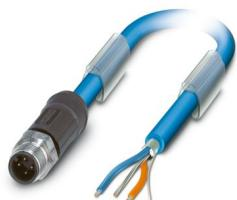
Cavo di sistema bus, PROFIBUS PA (31,25 kBit/s), 3-poli, PVC, blu RAL 5015, schermata, Maschio diritto M12, codifica: A, su estremità conduttore libera, lunghezza cavo: 2 m, per area Ex con zigrinatura in acciaio inox
