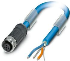
Cavo di sistema bus, PROFIBUS PA (31,25 kBit/s), 3-poli, PVC, blu RAL 5015, schermata, estremità conduttore libera, su Connettore femmina diritto M12, codifica: A, lunghezza cavo: 20 m, per area Ex con zigrinatura in acciaio inox
