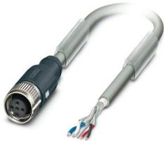
Cavo di sistema bus, CANopen®, DeviceNet™, 5-poli, PUR senza alogenati, grigio-argento RAL 7001, schermata, estremità conduttore libera, su Connettore femmina diritto M12 SPEEDCON, codifica: A, lunghezza cavo: 2 m, Connettore non schermato
