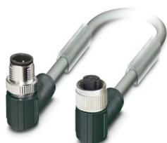
Cavo di sistema bus, CANopen®, DeviceNet™, 5-poli, PUR senza alogenati, grigio-argento RAL 7001, schermata, Maschio angolato M12 SPEEDCON, codifica: A, su Connettore femmina angolato M12 SPEEDCON, codifica: A, lunghezza cavo: 10 m, Connettore non schermato
