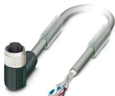
Cavo di sistema bus, CANopen®, DeviceNet™, 5-poli, PUR senza alogenati, grigio-argento RAL 7001, schermata, estremità conduttore libera, su Connettore femmina angolato M12 SPEEDCON, codifica: A, lunghezza cavo: 2 m, Connettore non schermato
