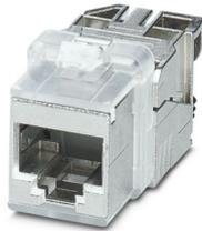
Inserto connettori femmina RJ45, tipo: RJ45, grado di protezione: IP20, numero poli: 8, 10 Gbit/s, CAT6<sub>A</sub>, materiale: Metallo, tipo di connessione: Connessione IDC, sezione di connessione: AWG 26- 22, uscita cavo: diritto, Versione Keystone per l'impiego con telaio di montaggio IP20 o per l'integrazione diretta nella parete della custodia, Ethernet
