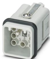
Inserto contatti, numero poli: 7+PE, dimensioni: D7, numero di connessioni per polo: 1, Spina, Connessione a crimpare, 400 V, 12 A, 0,14 mm<sup>2</sup> ... 2,5 mm<sup>2</sup>
