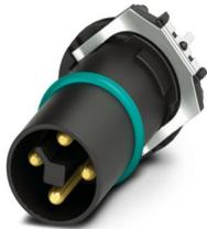
Portacontatti, Potenza, 4-poli, Connettore, diritto, M12, codifica: T, Montaggio dei circuiti stampati, Attacco a saldare THR, Questo articolo è in continuo adattamento. Alternativa senza piombo secondo RoHS II senza eccezione 6c (Pb < 0,1%) possibile in anticipo su richiesta.
