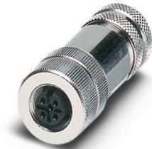
Connettore, 5-poli, schermata, Femmina diritto M12, codifica: A, Connessione a vite, materiale zigrinato: Pressogetto di zinco, nichelato, connessione a vite per cavo Pg11, diametro esterno conduttore 8 mm ... 10 mm
