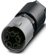
Connettore, product family: QPD, tipo di connessione: Connessione IDC, numero poli: 4+PE, 2,5 mm<sup>2</sup> ... 6 mm<sup>2</sup>, 690 V, 40 A, PA, nero, con dado QUICKON, diametro esterno conduttore: 9 mm .
