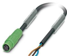
Cavo sensore/attuatore, 3-poli, PUR senza alogenati, grigio-nero RAL 7021, estremità conduttore libera, su Connettore femmina diritto M8 Snap-in, codifica: A, lunghezza cavo: 3 m, con capocorda
