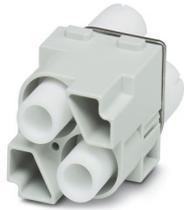
Modulo portacontatti, numero poli: 2, contatti di potenza: 2, contatti di comando: 0, Spina, Connessione a crimpare, 2900 V/5000 V, 16 A, 0,5 mm<sup>2</sup> ... 4 mm<sup>2</sup>, applicazione: ad alta tensione
