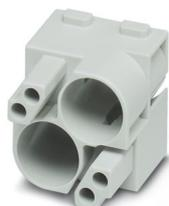
Modulo portacontatti, numero poli: 2, Femmina, Connessione a crimpare, 48 V, 10 A, 0,14 mm<sup>2</sup> .. 2,5 mm<sup>2</sup>, applicazione: Dati/segnale, per l'impiego di due connettori EMC (connettori femmina), numero di poli: 1, 4, 8
