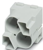
Modulo portacontatti, numero poli: 2, Spina, Connessione a crimpare, 48 V, 10 A, 0,14 mm<sup>2</sup> ... 2,5 mm<sup>2</sup>, applicazione: Dati/segnale, per l'impiego di due connettori EMC (spine), numero di poli: 1, 4, 8
