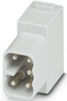
Modulo portacontatti, numero poli: 5, contatti di potenza: 5, contatti di comando: 0, Spina, Connessione Push-in, 400 V, 16 A, 0,14 mm<sup>2</sup> ... 2,5 mm<sup>2</sup>, applicazione: Potenza
