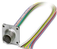
Connettore per apparecchi anteriore, 12-poli, Femmina, diritto, M12, codifica: A, su estremità conduttore libera, Montaggio anteriore/flangia quadrata, Fili singoli, lunghezza cavo: 0,07 m, 0,08 mm<sup>2</sup>, saldato, Questo articolo è in continuo adattamento. Alternativa senza piombo secondo RoHS II senza eccezione 6c (Pb < 0,1%) possibile in anticipo su richiesta.
