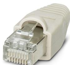
Connettore RJ45, tipo: RJ45, grado di protezione: IP20, numero poli: 8, 1 Gbit/s, CAT5 (IEC 11801:2002), materiale: Plastica, tipo di connessione: Connessione a crimpare, sezione di connessione: AWG 26- 23, uscita cavo: diritto, Ethernet
