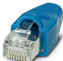
Connettore RJ45, tipo: RJ45, grado di protezione: IP20, numero poli: 8, 1 Gbit/s, CAT5 (IEC 11801:2002), materiale: Plastica, tipo di connessione: Connessione a crimpare, sezione di connessione: AWG 26- 24, uscita cavo: diritto, Ethernet
